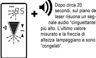
Dopo circa 20 secondi, sul piano del laser risuona un segnale audio "cinguettante" più alto. L'ultimo valore misurato e la freccia di altezza lampeggiano e sono "congelati".
